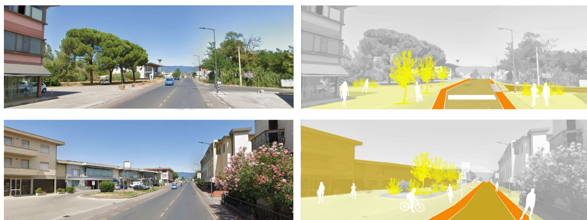
Figura 10 | Stato di fatto e stato di progetto, con allargamento della sede pedonale e riconfigurazione del sistema di spazi aperti pubblici. Fonte: Eleonora Gianni.
