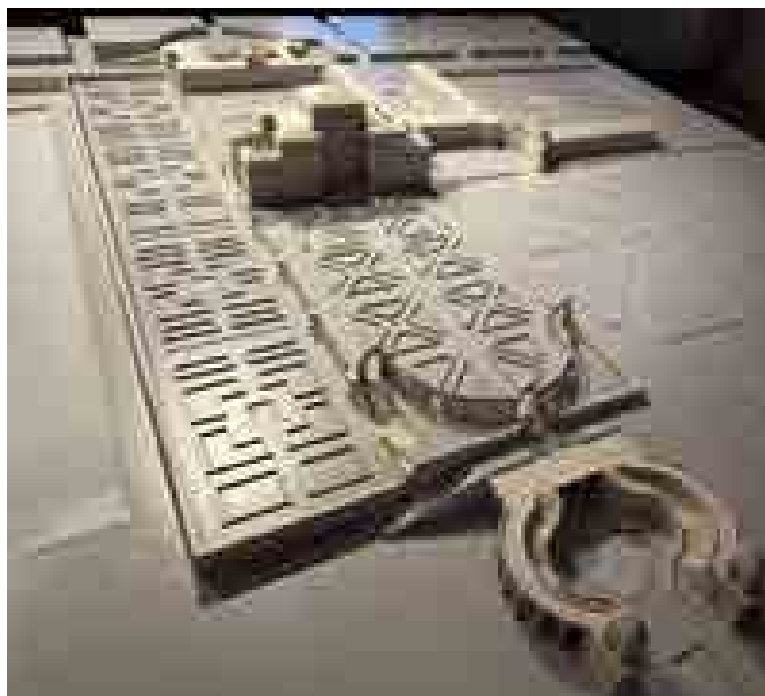
Figg. 154-155: In basso, modello della residenza nel XVII secolo, realizzato da Tech:art srl con consulenza scientifica di Paolo Cornaglia in resina sintetica lavorata tramite fresatura e prototipazione rapida, trattamento superficiale verniciatura monocromatica opaca, scala 1:200. (Foto autore maggio 2025).
