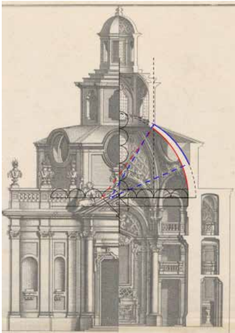
Figura 5. Analisi del tracciato geometrico del progetto per la cupola della chiesa di Santa Chiara a Torino (secondo il progetto non realizzato) (da VITTONI 1766, tav. LXX; elaborazione di G. De Lucia).
