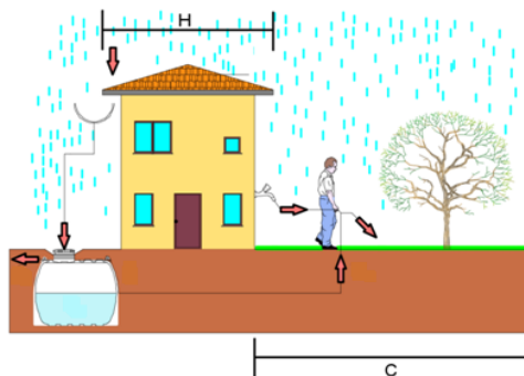
Figura 1. Schema del sistema di raccolta dell'acqua piovana: H area di captazione, C area irrigata.
