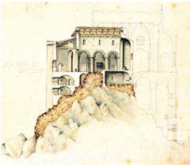
fig. 6 – ALFREDO D'ANDRADE, sezione ricostruttiva della chiesa dell'XI secolo, disegno a matita, s.d. (Torino, Soprintendenza Archeologia Belle Arti e Paesaggio, Archivio storico , 991/3/212).
