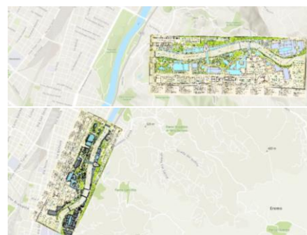
Figure 3. Mappa visualizzata con rotazione scorretta in Map Viewer Classic (alto) e corretta in Map Viewer (basso), su mappa di base World Topographic Map (ESRI).
