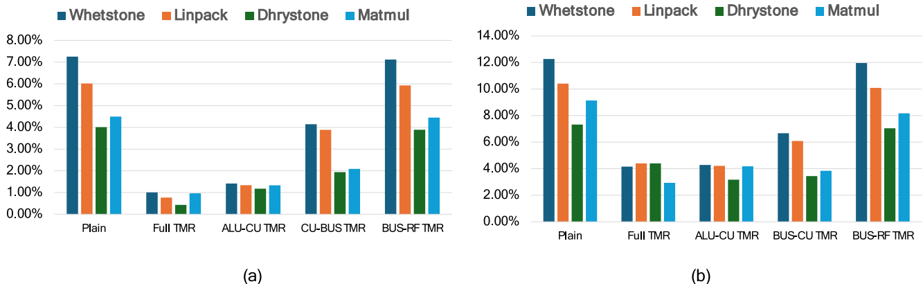
Fig. 5. (a) SEU Error Rates (b) MBU Error Rates.
