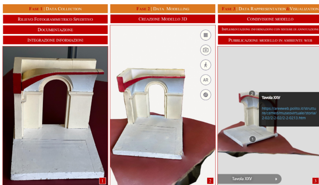
Fig. 7 - Workflow digitalizzazione modello e visualizzazione in Sketchfab : 1. rilievo fotogrammetrico speditivo e integrazione con documentazione di archivio; 2. Creazione modello con app Polycam per Iphone 14; 3. Condivisione modello all'interno dell'ambiente virtuale Sketchfab e implementazione dei dati e dei metadati del modello mediante l'utilizzo di annotazioni (modello ed elaborazione grafica di Mariapaola Vozzola).
