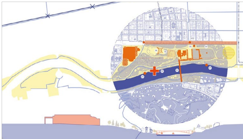
5: Macro-interventi previsti nel Transetto Valentino. 15. Estensione superfici permeabili; 21. Inserimento di piattaforme sul fiume; 31. Inserimento di nuova passerella pedonale; 315. Inserimento di nuovi attraversamenti pedonali; 32. Ripristino e riposizionamento dell'attracco; 33. Riposizionamento parcheggio auto; 35. Inserimento nuovo noleggio biciclette; 47. Brandizzazione.
