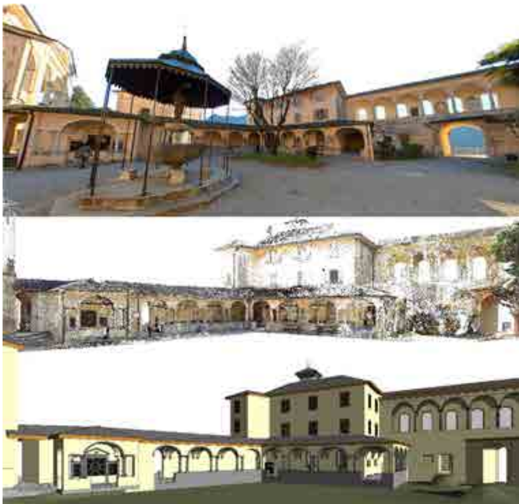
3: Sacro Monte di Varallo, fasi della digitalizzazione (dall'alto: bene fisico, nuvola di punti, modello HBIM) del complesso della Pietà, in affaccio sulla Piazza della Basilica.
