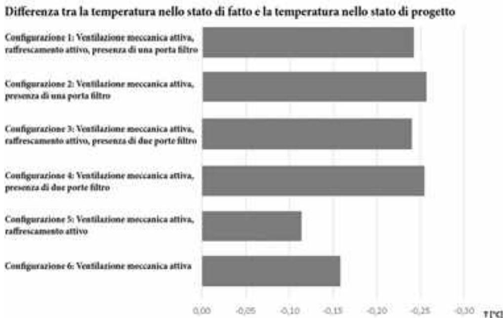
3: Differenza di temperatura nella sala dei Tirannici tra lo stato di fatto e lo stato di progetto in sei ipotesi di configurazione tecnologica e tecnica del varco tecnologico CapsulART.
