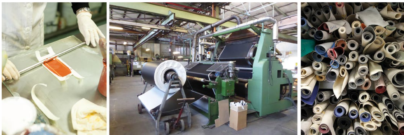
Fig. 2 - Alcune fasi del processo produttivo all'interno dello stabilimento Resinflex in via Reiss Romoli, Torino. Da sinistra: la preparazione dei campioni di paste da spalmatura e dei coloranti nel laboratorio chimico, goffratura, magazzino campioni (foto L. Ferrando-Archivio Resinflex; foto T. Marzi).
