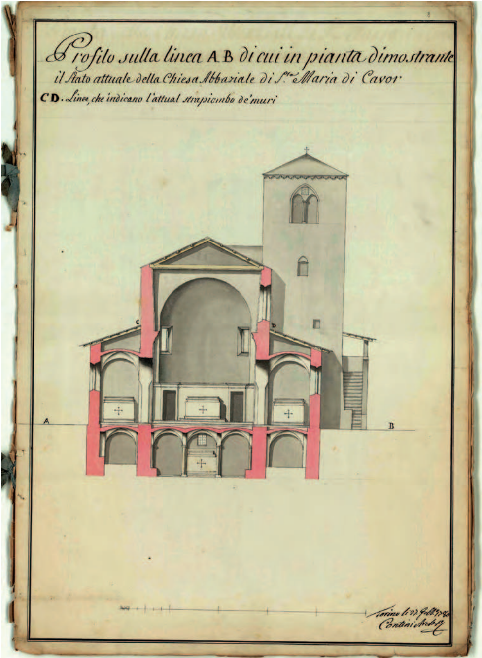
Fig. 2. Profilo sulla linea AB di cui in pianta dimostrante il stato attuale della chiesa abbaziale di S.ta Maria di Cavor , G.M. Contini, 1780 (da MORETTI 2019).
