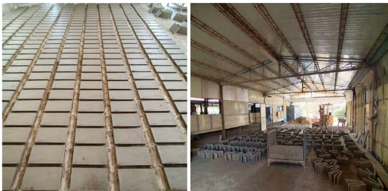
Figura 5. Laterizi di Castel Viscardo lavorati a mano in fase di preparazione per la “cotta”
