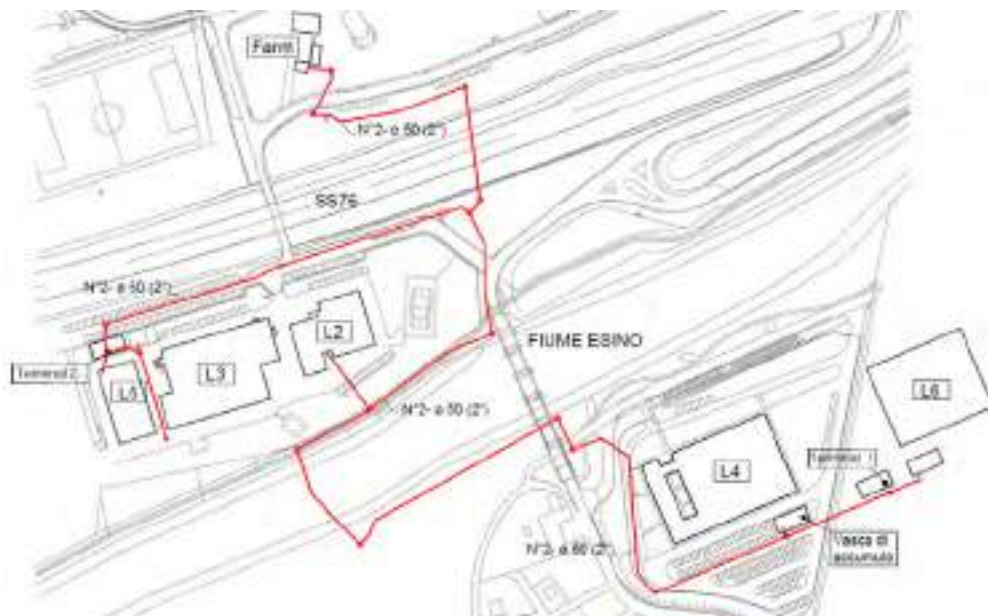
Figura 3. Planimetria generale della smart grid termica
