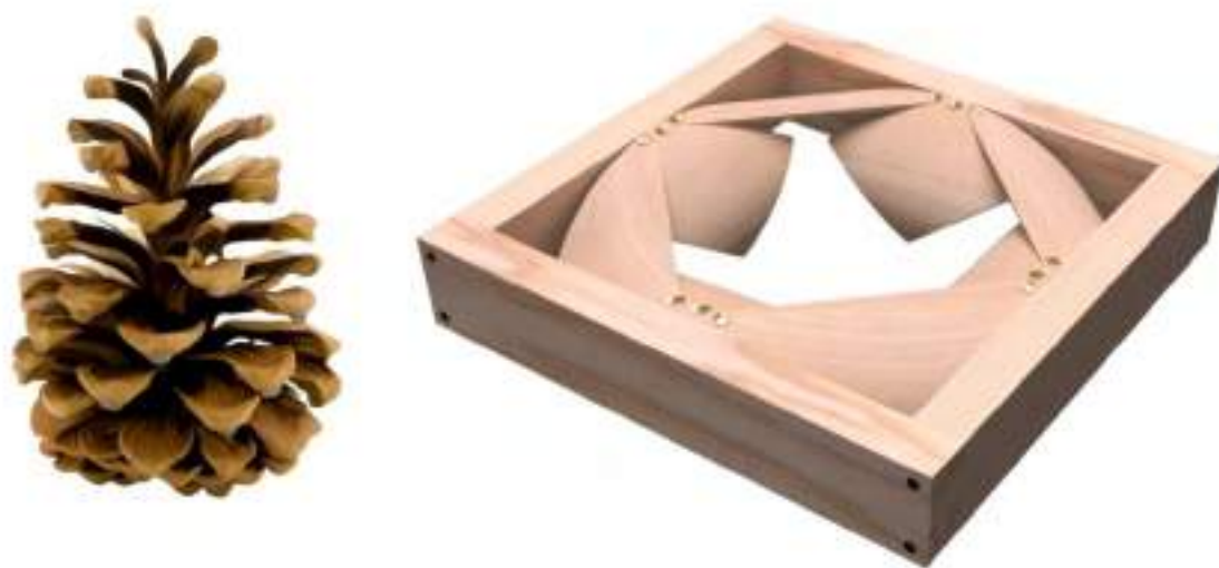
Figura 3. Il comportamento del pannello “decompensato” replica quello delle pigne.
