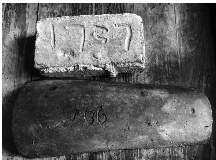
Fig. 2. Coppo e mattone risalenti all’epoca di costruzione della villa, con impressa la data di produzione, rispettivamente 1736 e 1737.
