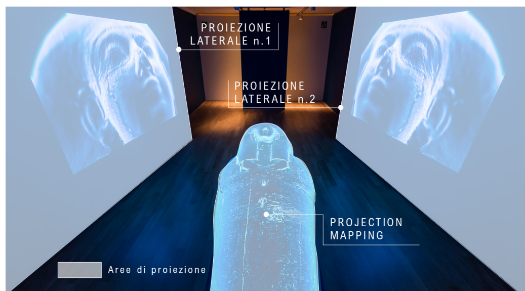
Fig. 02. Schema e disposizione finale dell'installazione che ha visto l'integrazione tra projection mapping e la proiezione sincronizzata su due schermi posti lateralmente alla replica 3D del sarcofago di Butehamon (Elaborazione immagine: Davide Mezzino).
