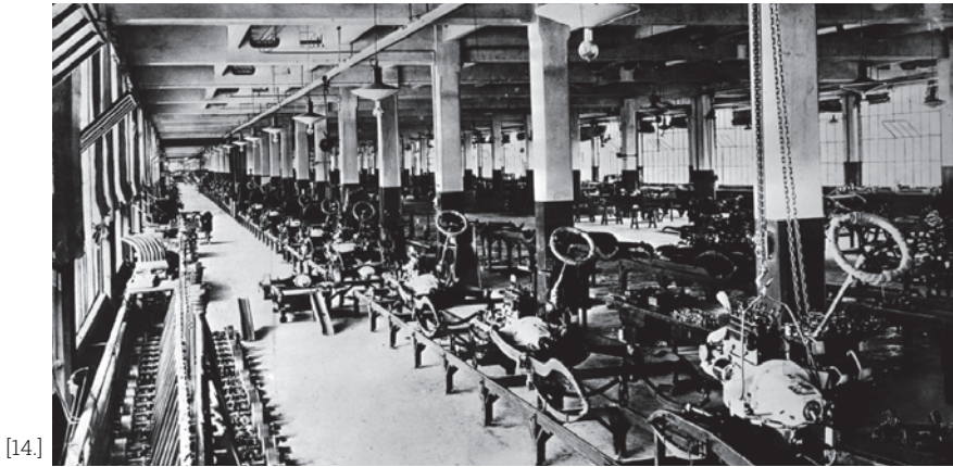
Fig. 14. FIAT Officine Lingotto. Montaggio chassis , su concessione Centro Storico FIAT, ASF 1924.
