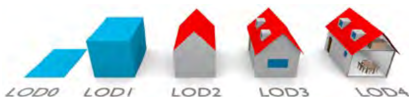
Figura 1 Livelli di dettaglio definiti dal CityGML 2.0. BIJECKI, LEDOUX, STOTER, 2016.
