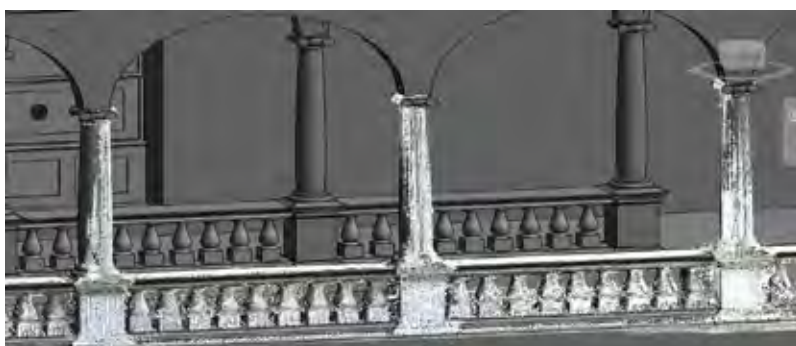
Figura 10 Confronto tra la nuvola di punti e il modello HBIM – colonnato.
