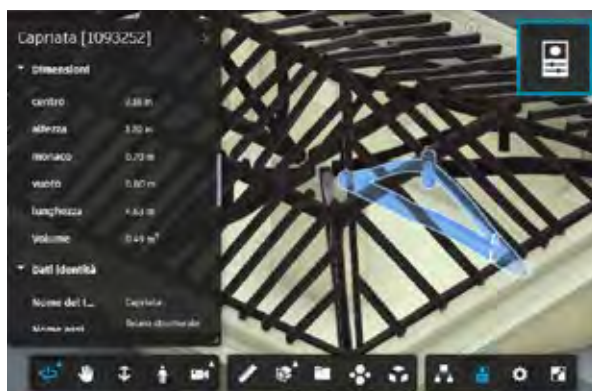
Figura 12 Pannello delle proprietà di una capriata all'interno del sottotetto della Cappella 38 del Sacro Monte di Varallo
