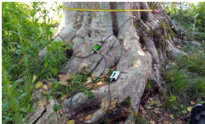
Figura 10 Tomografia sonora della sezione di un platano, si vedono i sensori posizionati sulla circonferenza
