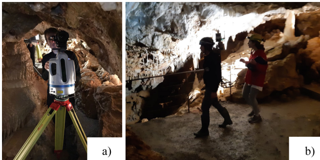
Fig. 2. a) Teledyne Optec Polaris. b). KAARTA Stencil 2.
