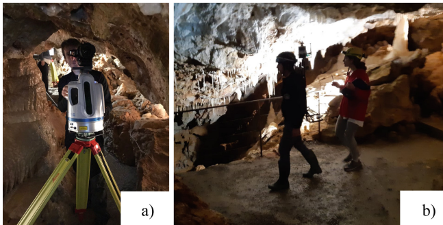
Fig. 2. a) Teledyne Optec Polaris. b). KAARTA Stencil 2.
