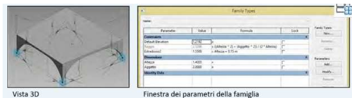
Figura 9 Modello generico metrico adattivo per la modellazione di una volta a crociera.
