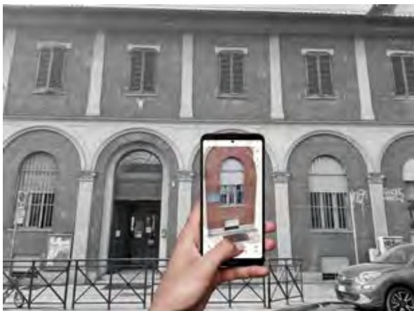
Figura 2 Esempio di rilievo speditivo di un fronte mediante utilizzo di distanziometro laser e app collegata.
