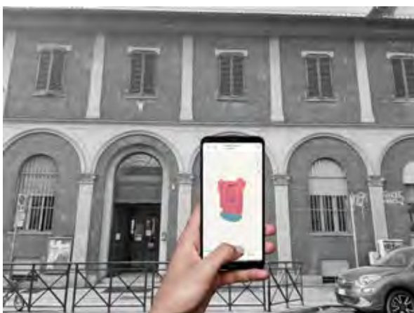
Figura 4 Esempio di rilievo speditivo di un fronte mediante fotocamera LiDAR e app.
