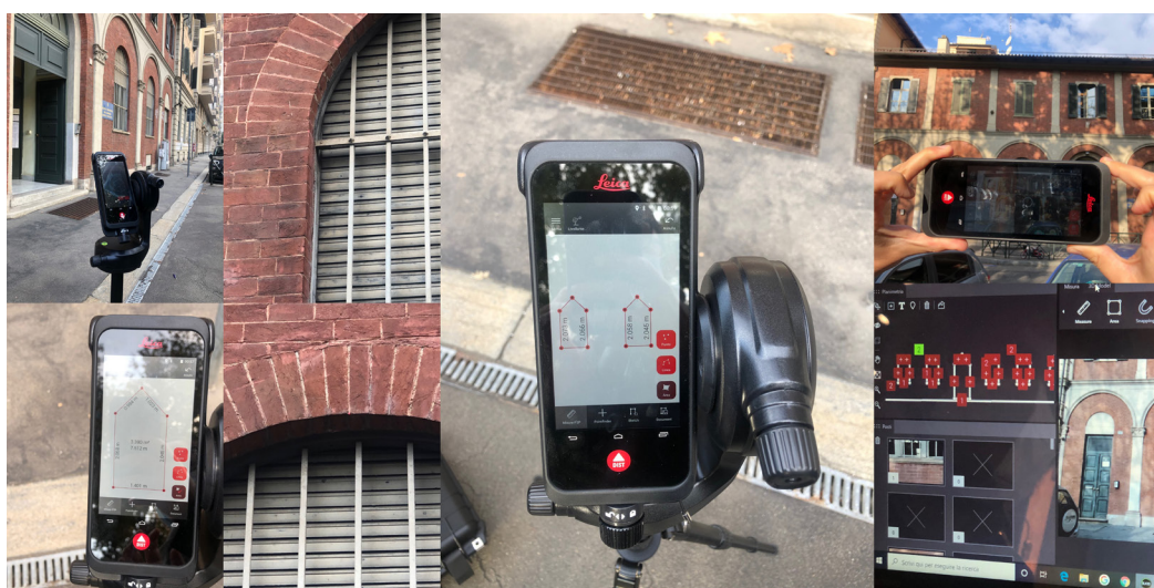
Fig. 06. iPhone 12PRO durante l'acquisizione della nuvola di punti elaborata all'interno dell'app Polycam, all'interno della quale è possibile effettuare in tempo reale delle misurazioni dei manufatti rilevati. Elaborazione a cura dell'autore
