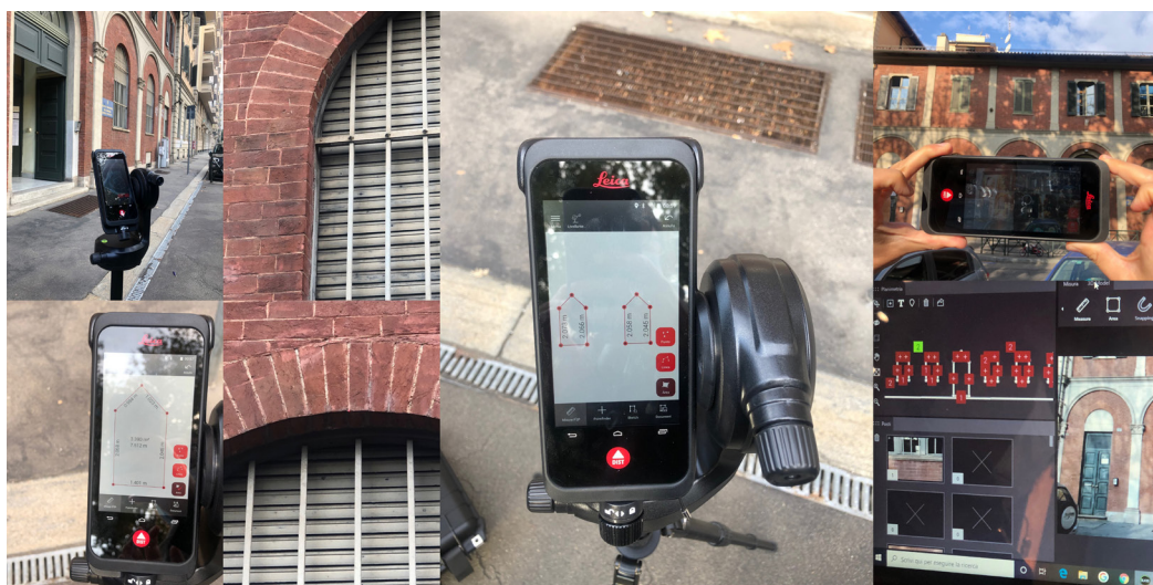
Fig. 06. iPhone 12PRO durante l'acquisizione della nuvola di punti elaborata all'interno dell'app Polycam, all'interno della quale è possibile effettuare in tempo reale delle misurazioni dei manufatti rilevati. Elaborazione a cura dell'autore
