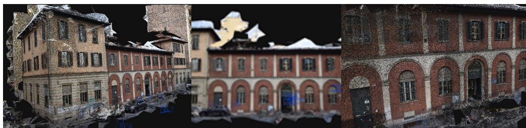
Fig. 08. Alcune immagini della nuvola di punti generata all'interno del software 3D Zephyr Free 5.019. Elaborazione a cura dell'autore
