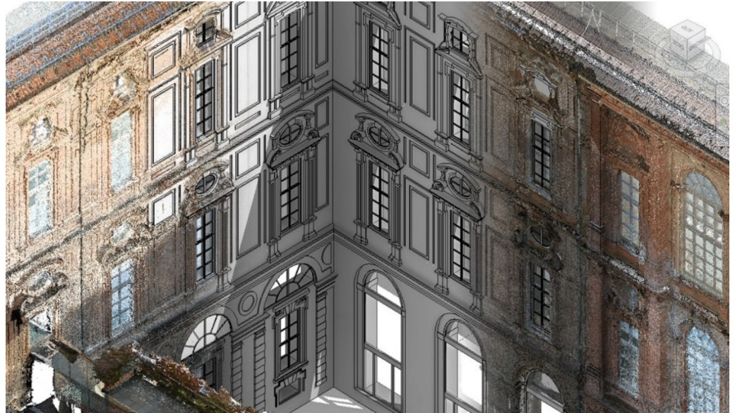
Figure 1. From the point cloud to HBIM model. Virtual model of the Fondazione Museo delle Antichità Egizie di Torino.
