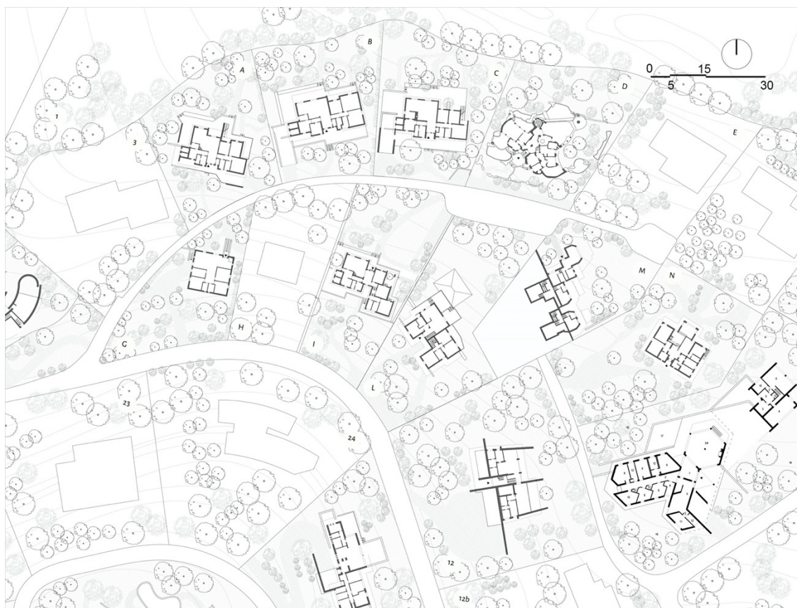
217. Ridisegno del comparto del Poggio del Barbieri. Elaborato prodotto attraverso la composizione dei ridisegni dei lotti – solo per le C.E. reperite –, confrontando con le tavole dei Piani di Comparto e le ortofoto aggiornate al 2019.
