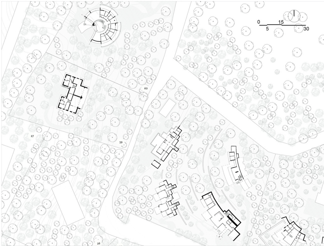
215. Ridisegno del comparto dello Scoglietto. Elaborato prodotto attraverso la composizione dei ridisegni dei lotti – solo per le C.E. reperite -, confrontando con le tavole dei Piani di Comparto e le ortofoto aggiornate al 2019.
