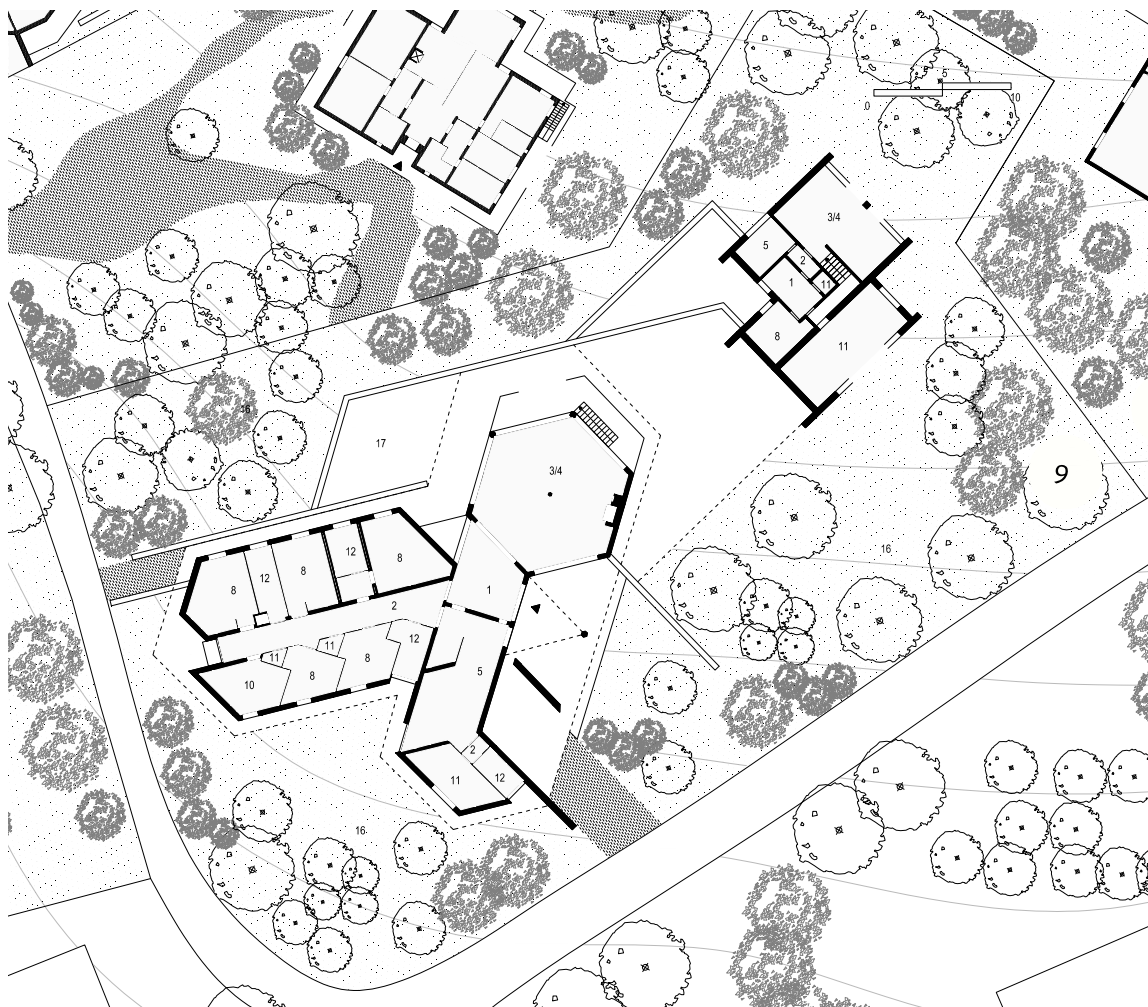
260. Ridisegno dello stato di progetto (1962) del piano primo: 1. Ingresso; 2. corridoio (distribuzione orizzontale); 3. soggiorno; 4. salotto; 5. cucina; 6. soggiorno esterno; 8. camera da letto; 9. studiolo; 10. camera per gli ospiti; 11. stanza di servizio; 12. bagno; 14. patio/terrazza; 16. giardino; 17. piscina.
