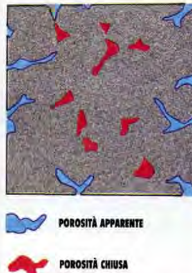
Figura 2: schematizzazione di un provino lapideo. In colore bleu, la porosità aperta (o porosità apparente), accessibile; in colore rosso, la porosità chiusa, non accessibile. La somma delle porosità in bleu e in rosso rappresenta la porosità totale
