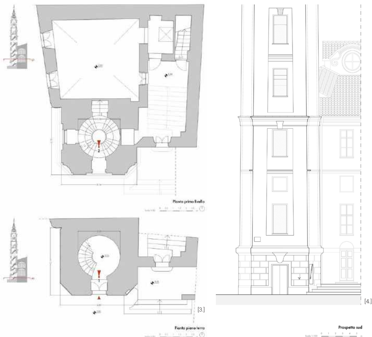
Figg. 3-4. Pianta piano terra e primo livello, prospetto sud (stralcio) del campanile, rilievo dello stato di fatto [in originale scala 1:50 – 1:100, elaborati grafici a cura di A. Barbero, G. Bonito, F. Calosso, 2020].
