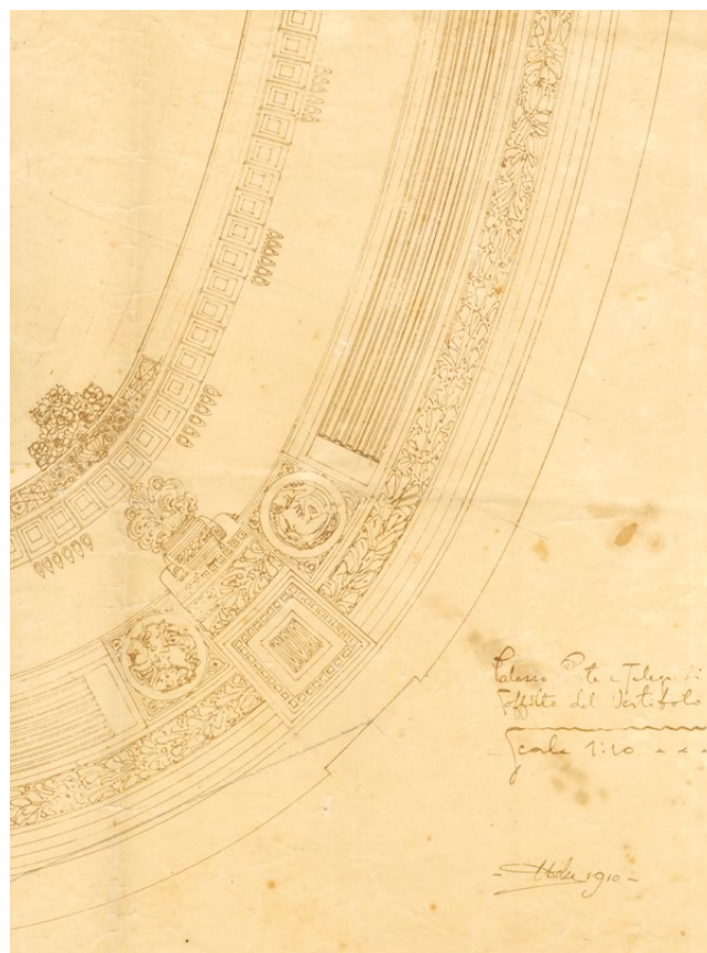
fig. 4 – CAMILLO DOLZA, Palazzo Poste e Telegrafi . Soffitto del vestibolo, copia eliografica su carta con tracce di matita, scala 1:10, 1910 (PoliTo DIST-LSBC, Musso Clemente, MC. 57).
