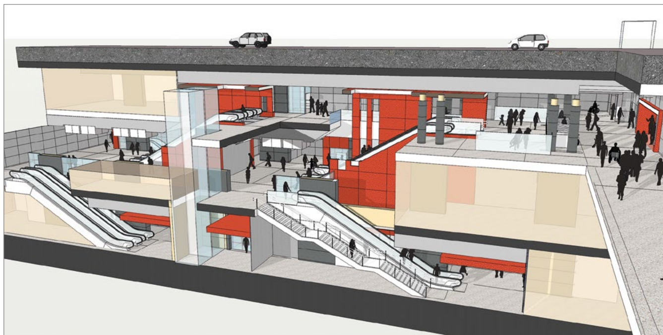
Metropolitana di Torino, Linea 2, stazione a tre livelli: schizzo dell'organizzazione funzionale.
