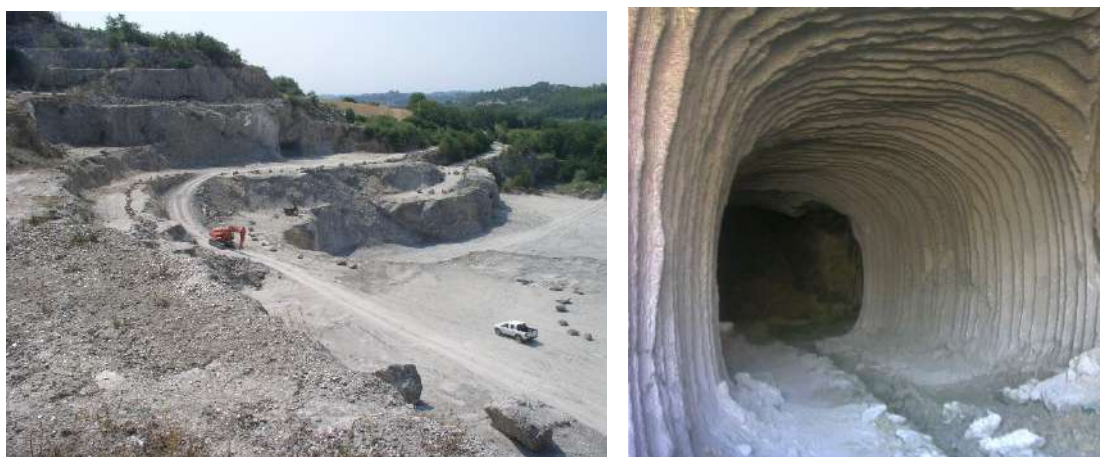
Fig. 2 a. Cava di gesso a cielo aperto. b. Galleria di una cava di gesso in sotterraneo, scavata con fresa meccanica
