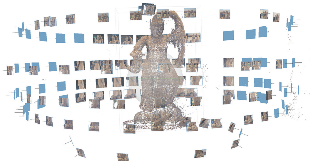
Fig. 4. Allineamento delle foto con nuvola sparsa (riprese fotografiche di F. Ronco e S. Tamantini).
