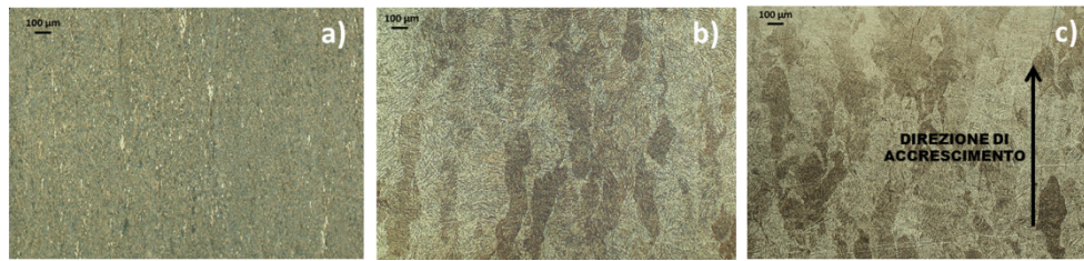
Fig.1 - Immagini acquisite mediante microscopio ottico lungo la direzione di laminazione per il campione Ti6Al4V (a) e lungo la direzione di accrescimento per i campioni LM_DMLS vergine (b) e LM_DMLS 1° riciclo (c)
