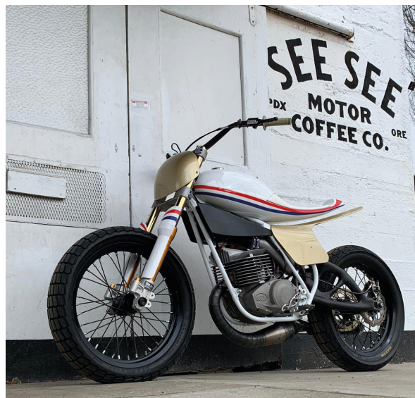
Fig.2 - La moto "The Lunar project" della start-up Carboni e Metalli: diversi suoi componenti sono stati prodotti in SLM da BEAMIT
