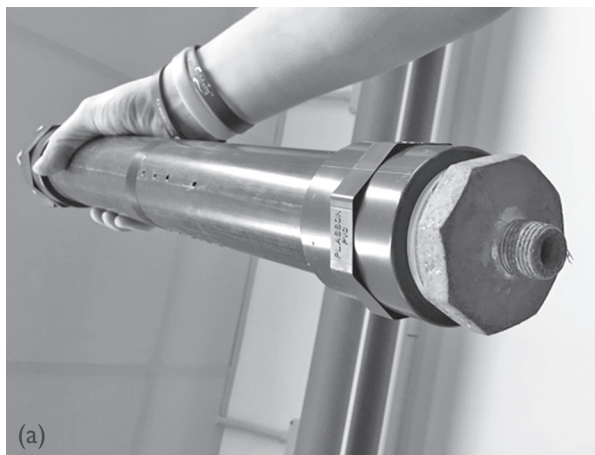
Fig. 2. Dettaglio del tubo di prova: particolare del raccordo di chiusura posteriore del tubo (a); particolare del raccordo di chiusura anteriore del tubo da connettere al generatore di schiuma (b). Detail of the test pipe: particular of the back connection (a); particular of the front connection which is connected with the foam generator (b).
