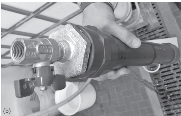
Fig. 2. Dettaglio del tubo di prova: particolare del raccordo di chiusura posteriore del tubo (a); particolare del raccordo di chiusura anteriore del tubo da connettere al generatore di schiuma (b). Detail of the test pipe: particular of the back connection (a); particular of the front connection which is connected with the foam generator (b).
