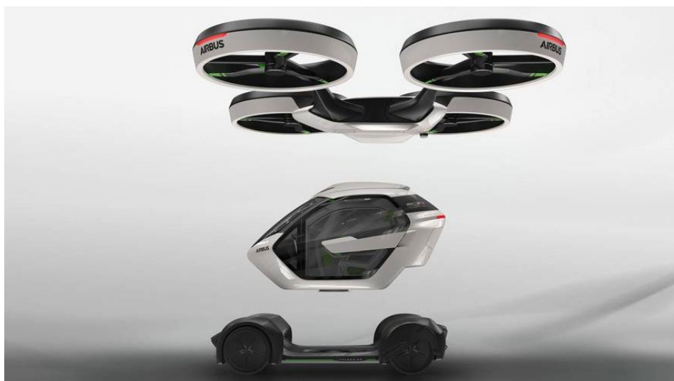
Fig. 1 - I tre moduli del sistema di trasporto Pop.Up progettato da Italdesign
