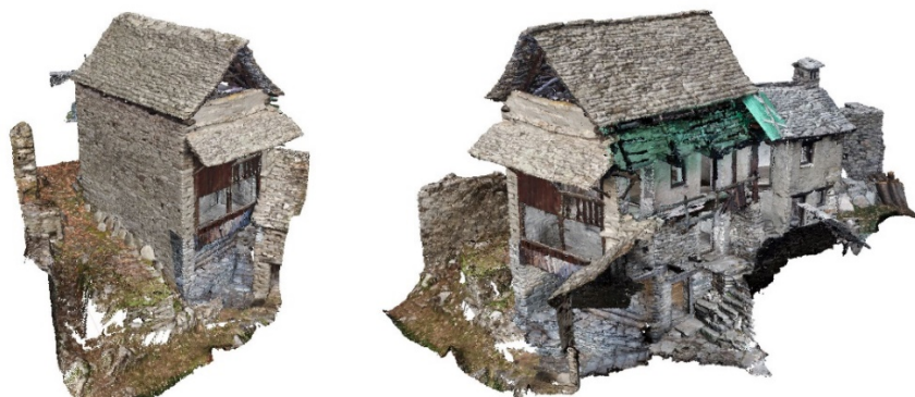
Fig. 6. Viste 3D della nuvola di punti fotogrammetrica derivata dall'unione tra il dataset aereo (superfici esterne) e quello terrestre (outdoor e indoor).
