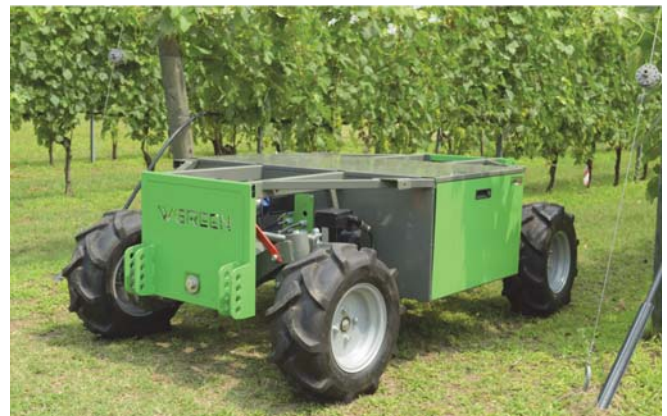
Fig. 6. The 4WS UGV designed and realized by Università di Torino (credit:DISAFA).
