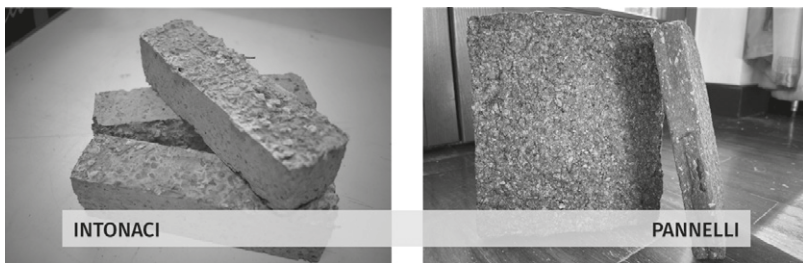
Figura 5 - Provini di intonaci e pannelli realizzati con scarti di nocciole [Elaborazione J. Andreotti].
