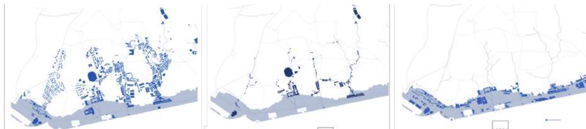
Figura 1 | Mappa degli elementi esposti al rischio per l'innalzamento del livello del mare previsto (a sinistra, edifici a rischio di instabilità: posizione sui pendii a partire da canali idrici fino a 100 m di distanza; al centro, edifici a rischio di immersione: posizionamento all'interno di canali fluviali e aree depresse; a destra, edifici a rischio di alluvione: ubicazione a quota 5m a partire dal fiume).
