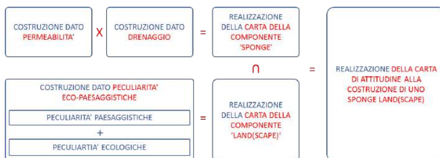
Figura 2 | Schema metodologico generale per la realizzazione della Carta di attitudine alla costruzione di uno SPONGE LAND(SCAPE).
