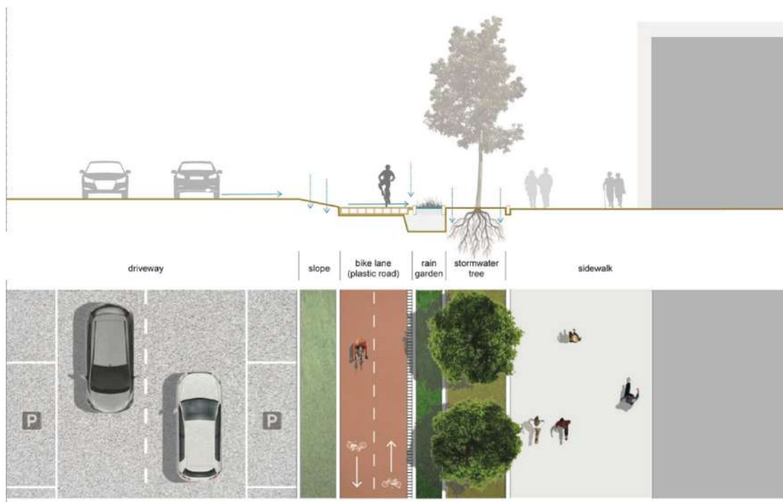
Figura 3 | Zwolle, sezione e planimetria della Plastic Road in Deventerstraatweg. Fonte: elaborazione originale dell'arch. Massimo Padrone.
