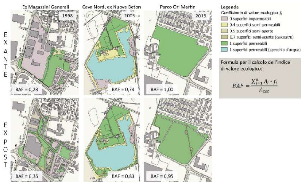
Figura 8 | Analisi del GSF relativa ai tre casi studio per la situazione ex ante ed ex post
