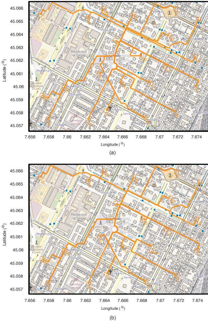
Figura 8. Función OF\_feeder : (a) Rutas desde la CO hasta los PSC generadas por la primera iteración de la función (usando una versión modificada de Dijkstra) (b) Rutas óptimas determinadas una vez que el algoritmo converge
