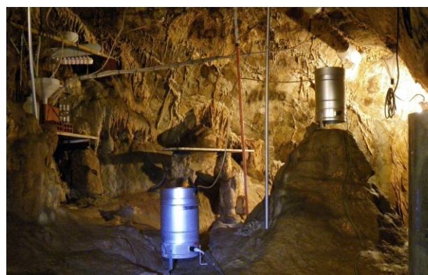
Foto 20 – I pluviografi per rilevare la portata degli stillicidi
