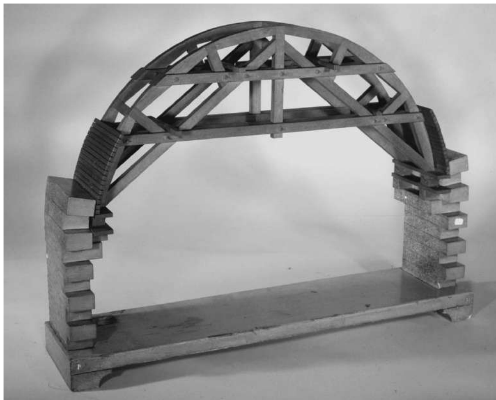
Fig. 5 – Laboratorio per la costruzione dei modelli dei cavv. Blotto e Vittorio Canepa Torino, Modello di armatura per la costruzione di grandi archi, XIX secolo (Politecnico di Torino, Dipartimento di Ingegneria Strutturale, Edile e Geotecnica, Collezione di modelli di costruzioni).
