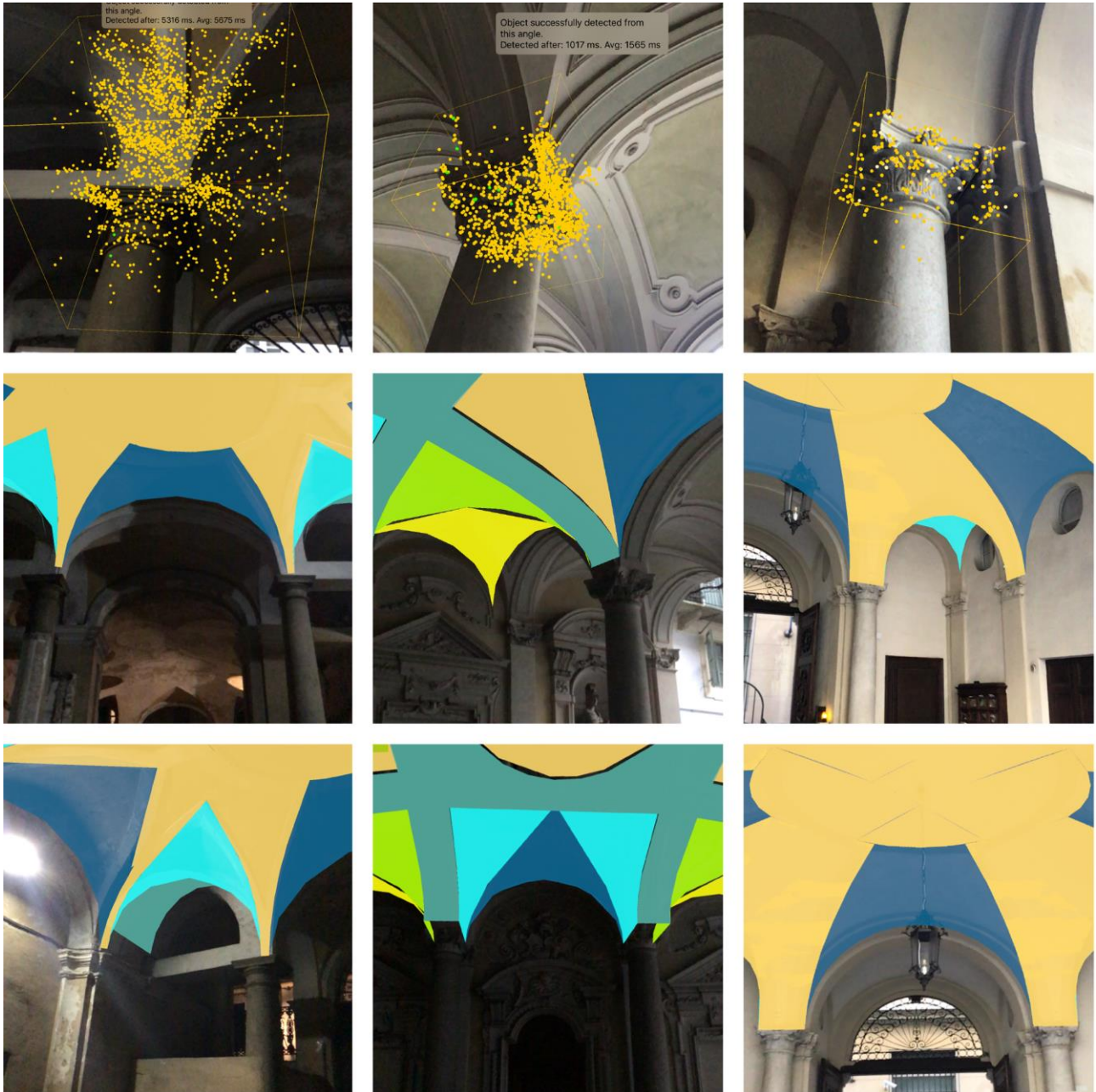
Figura 5. Applicazioni di AR basate su model tracking . Dalla colonna sinistra: Palazzo Novarina, Palazzo Coardi di Carpenetto, Palazzo Cigliano. Le immagini superiori mostrano le fasi di produzione della nuvola di punti per l'ancoraggio. Immagine tratta da Palma et al., 2019b.
