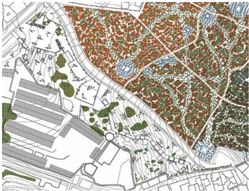
Figura 11. Detalle del plan en su límite suroeste, con el parque urbano de conexión. El punto de acceso a la Medina se encuentra al sur, con una plataforma-aparcamiento y un acceso peatonal. El perímetro de la muralla derruida se ha marcado con jardineras y muretes. Pueden distinguirse las “ qubbas sociales ” como pequeños módulos rectangulares a lo largo del sendero peatonal. En el noroeste se ubica el IGEPG, edificio semienterrado, una “muralla frente a la muralla” que envuelve el espacio público. Fuente: autor.
