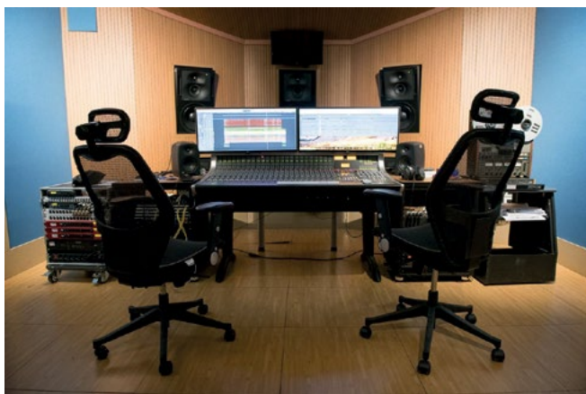
Figura 6a (a sinistra). La Control Room del Conservatorio: in primo piano la console Solid State Logic AWS948; sullo sfondo, tre delle casse amplificate Genelec parte del sistema di diffusione audio 5+2 (foto Conservatorio Giuseppe Verdi di Torino).
