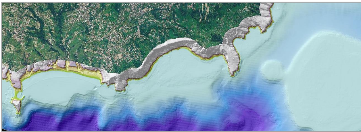
Figura 34 - Esempio di rappresentazione della batimetria costiera (4x4 metri) in continuità con il DTM terrestre a identica risoluzione (AMP Regno di Nettuno - Isola d'Ischia, Campania ). [Fonte: Schermata da Visualizzatore Geoportale Nazionale]
