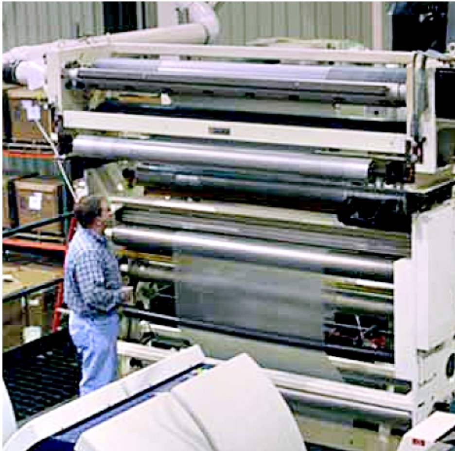
Fig. 4.3 - Ispezione di un trattatore universale, del tipo più utilizzato per migliorare le proprietà superficiali dei substrati prima della loro stampa o trasformazione.
