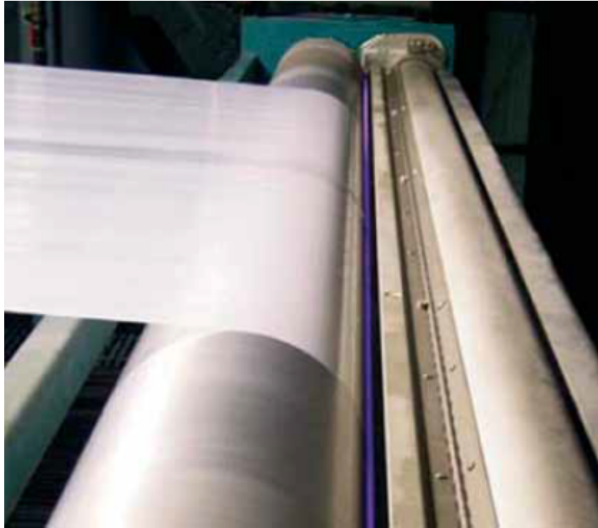
Fig. 1.3 - Un trattatore corona bare-roll corona (rullo non rivestito) per il trattamento del film o per il rinfresco della tensione superficiale. Notate la scarica tra gli elettrodi. In fisica la tensione superficiale misura una proprietà della superficie esterna di un materiale. Essa corrisponde microscopicamente alla densità superficiale di energia di legame sull'interfaccia tra un corpo continuo e un materiale di un'altra natura, solido, liquido o gassoso, e si misura in newton al metro (N/m) o dine al centimetro (dyn/cm). L'energia superficiale dipende dalla presenza di gruppi polari sulla superficie. Questi gruppi sono attivati dalla scarica corona.
