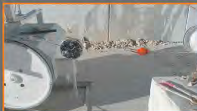
Fig.22 Fase di taratura del taglio al monte in configurazione 1, dinamometro su lato superiore del filo / Calibration of the upstream cut in layout 1, dynamometer on the upper side of the wire
