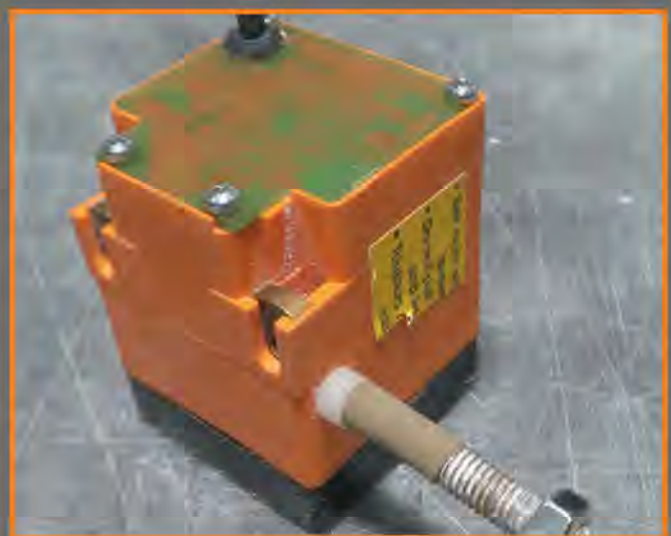
Fig.6 Estensimetro a filo (modello A40 prodotto dalla Kubler). Intervallo di misura 1000 mm, velocità massima 0,8 m/s, accuratezza \pm 0,15 mm, linearità \pm 0,35\% , intervallo di temperatura 0^{\circ} - 50^{\circ} / Draw-wire encoder (model A40, produced by Kubler). Measuring range: 1000 mm, maximum speed: 0.8 m/s, accuracy: \pm 0.15 mm, linearity: \pm 0.35\% , temperature range: 0^{\circ} - 50^{\circ}
