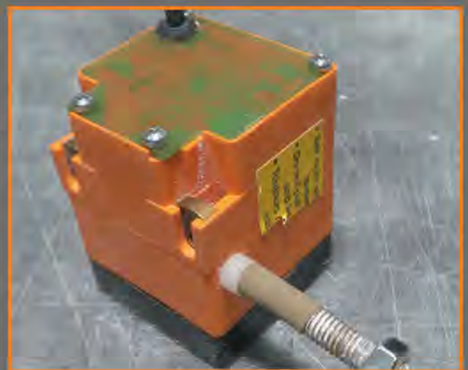
Fig.6 Estensimetro a filo (modello A40 prodotto dalla Kubler). Intervallo di misura 1000 mm, velocità massima 0,8 m/s, accuratezza \pm 0,15 mm, linearità \pm 0,35\% , intervallo di temperatura 0^{\circ} - 50^{\circ} / Draw-wire encoder (model A40, produced by Kubler). Measuring range: 1000 mm, maximum speed: 0.8 m/s, accuracy: \pm 0.15 mm, linearity: \pm 0.35\% , temperature range: 0^{\circ} - 50^{\circ}
