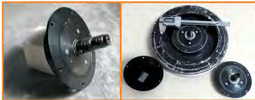
Fig.2 Rullo rilevatore di forza RMGZ 400 B. Forza nominale: 500 N. Dimensioni: d_1 85 mm, d_2 100 mm, d_3 110 mm - l_1 6.5 mm, l_2 4 mm, l_3 13 mm. Limite di velocità 8500 \text{min}^{-1} , coefficiente di carico C_{dyn} 11.8 kN, peso 0.75 kg, sensibilità 1.8 mV/V, classe di precisione \pm 0,1\% , resistenza in ingresso 350 \Omega RMGZ 400 force detector roller B. Nominal force: 500 N. Dimensions: d_1 85 mm, d_2 100 mm, d_3 110 mm - l_1 6.5 mm, l_2 4 mm, l_3 13 mm. Speed limit 8500 \text{min}^{-1} , load factor C_{dyn} 11.8 kN, weight 0.75 kg, sensitivity 1.8 mV/V, accuracy class \pm 0,1\% , input resistance 350 \Omega
