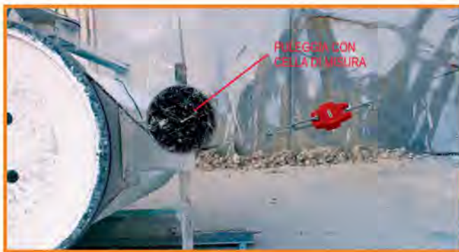
Fig.5 Taratura con dinamometro / Calibration with a dynamometer
