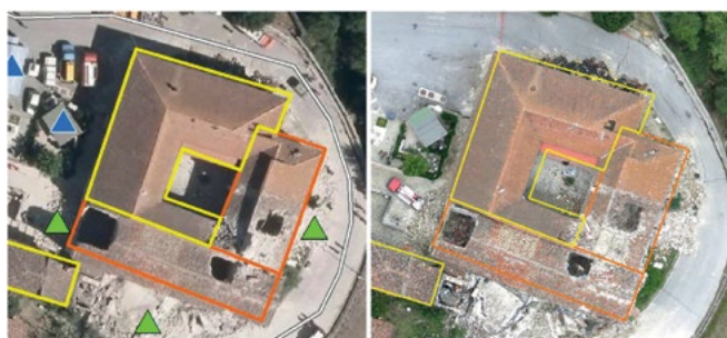
Figura 14. Integrazione dei dati UAVs per il BDA. L'edificio selezionato (indicato nell'immagine a sinistra con freccia bianca) non presentava danni evidenti nella sola ortofoto mentre si è rivelato essere gravemente danneggiato a seguito di un'ispezione del modello 3D (a destra).
