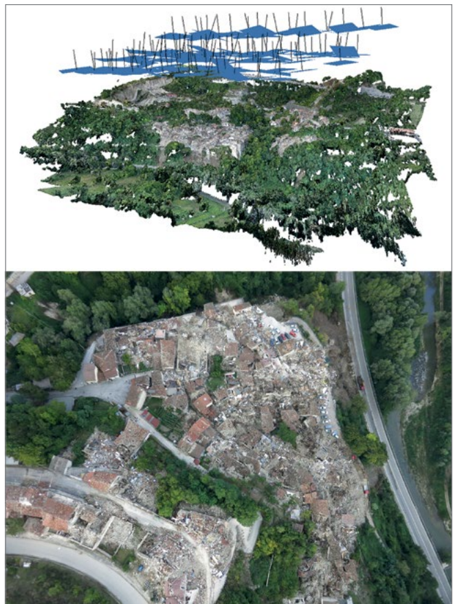
Figura 3. Lo schema del volo del T2 a Pescara del Tronto (alto) e un esempio delle immagini acquisite (basso).
