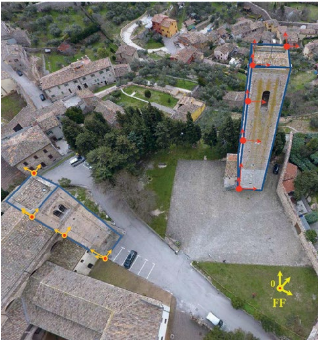
Figura 2. Schema del monitoraggio dinamico della Torre degli Smeducci e della torre del Duomo Vecchio.
