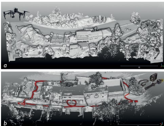
Figura 4. Confronto tra modelli: (a) nuvola DSM del volo fotogrammetrico UAV; (b) mappatura 3D da ZEBI mobile mapping system con visibilità della traiettoria percorsa, in rosso.
