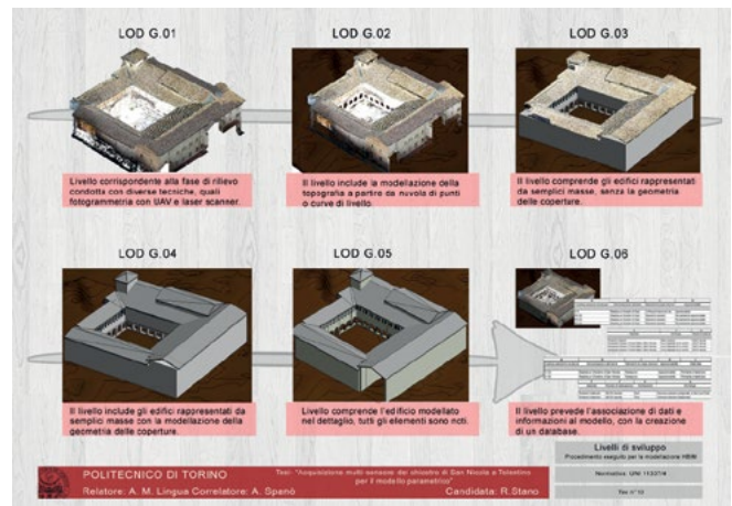
Figura 16. Proposta di organizzazione in sottolivelli del livello di sviluppo G della normativa I 1337/4 del 2017.
