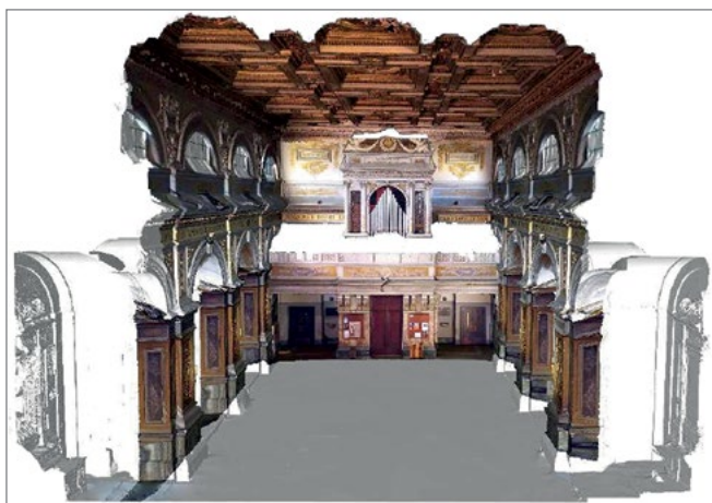
Figura 10. Modello 3D accurato derivato da scansioni laser e integrato con textures fotogrammetriche ad alta definizione della porzione del coro della chiesa e muratura di controfacciata, che rappresenta uno dei punti più critici dal punto di vista strutturale dell'intera basilica.
