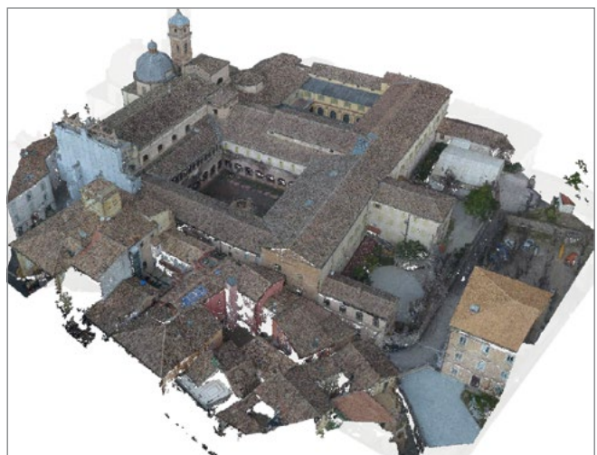
Figura 3. Nuvola di punti generata dall'elaborazione SfM di immagini del volo UAV, con riprese nadirali e inclinate (allieve: M.C. Polacco, B. Quaglio, A. Rabbia, J. Ravagli).
