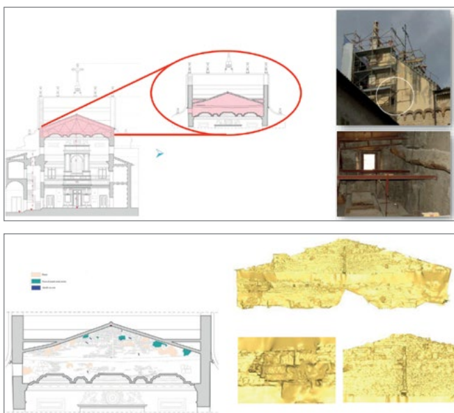
Figura 11. Studio delle lesioni del muro di controfacciata nel sottotetto della basilica di San Nicola. Restituzione della porzione di controfacciata del sottotetto nella sezione complessiva della chiesa (a) e analisi a scala maggiore a partire dalla modello continuo ricavato dalla nuvola LiDAR; con l'identificazione di murature di diverse tessiture, di rifazzi cementizi e identificazione di catene e altri apparati tecnologici metallici (b).
