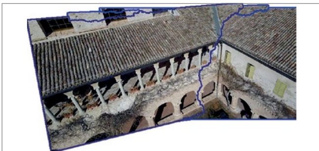
Figura 14. Esempio di analisi di unione di fotogrammi consecutivi estratti da video acquisiti da mini UAV.
